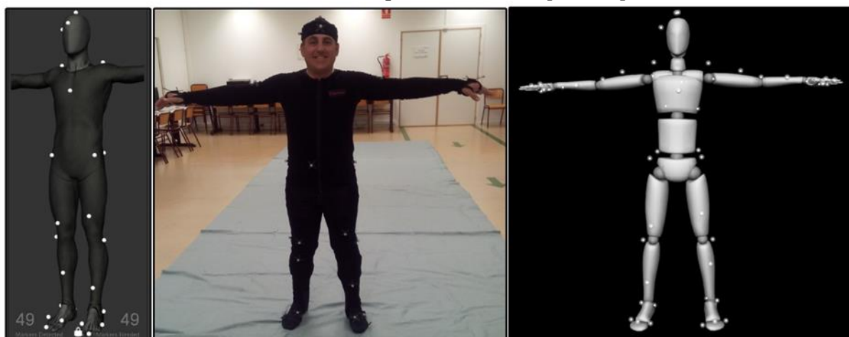
Figura 2. Izquierda: posición donde se deben colocar los marcadores. Centro: sujeto con traje y marcadores. Derecha: esqueleto detectado por la aplicación.
